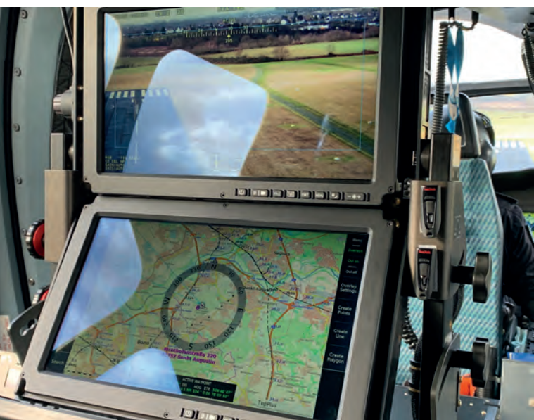
Live-Video des Kamerasystems und Darstellung der Position des BPOL-Hubschraubers auf der Karte
