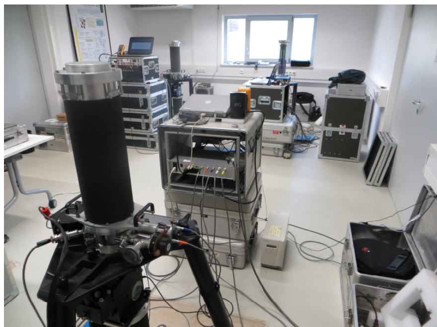
Abbildung 3-17: Vergleich der Absolutgravimeter des Instituts für Erdmessung der Leibniz Universität Hannover und des BKG im Gravimeterhaus am Geodätischen Observatorium Wettzell
