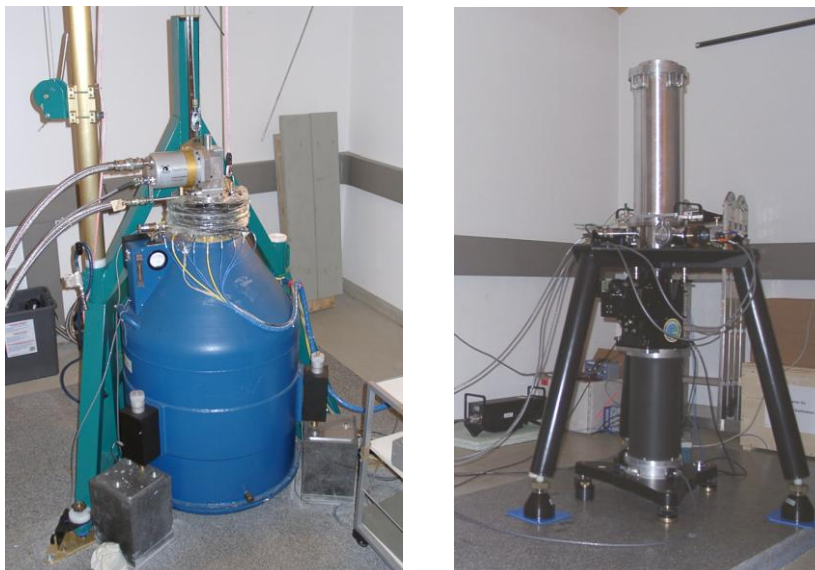
Abbildung 2.5: Supraleitendes Gravimeter SG 29 (links) und Absolutgravimeter FG5-301 (rechts)
