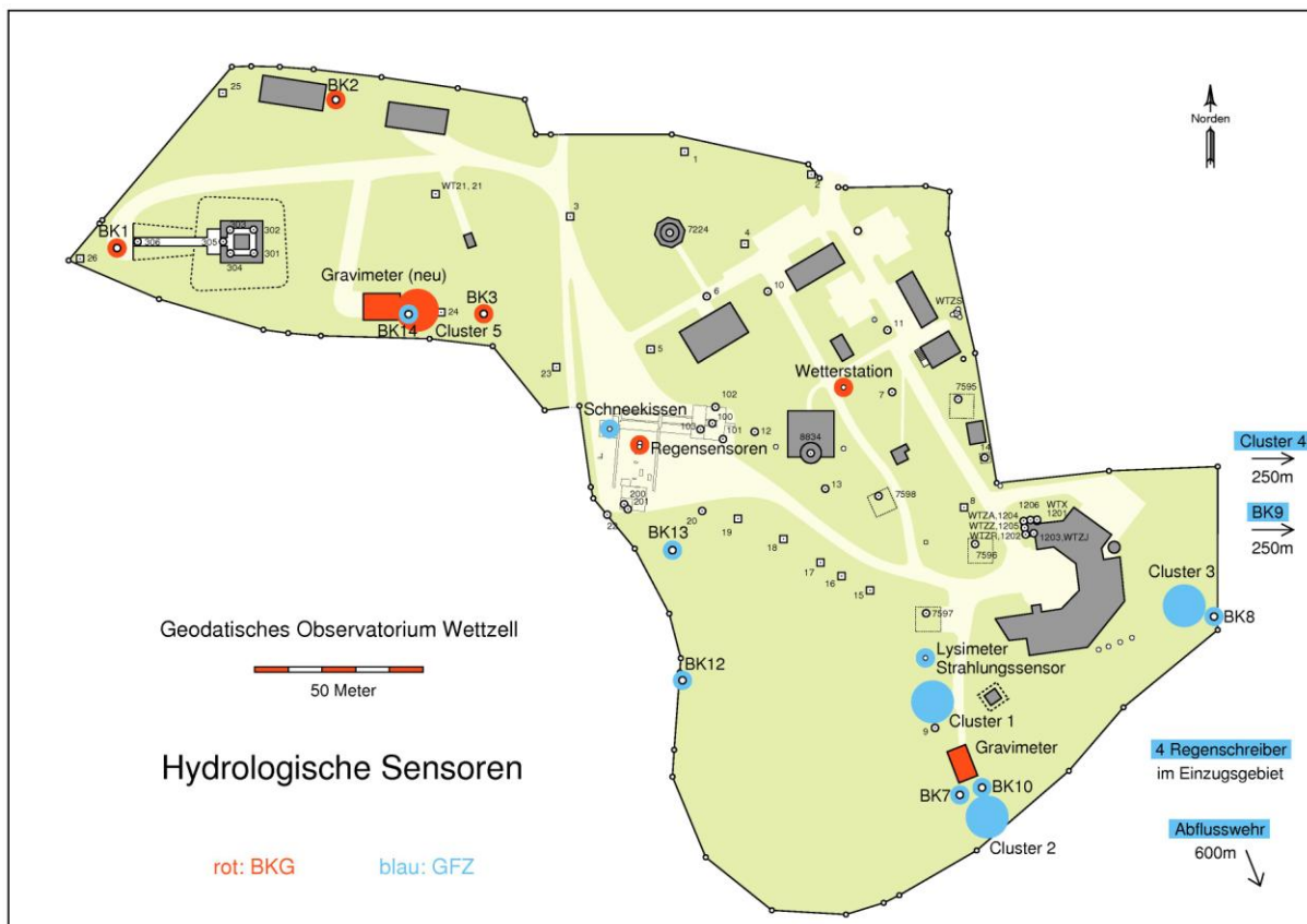
Abbildung 2.9: Installierte Hydrologische Sensoren und Vermessungsnetz auf dem Geodätischen Observatorium Wettzell
