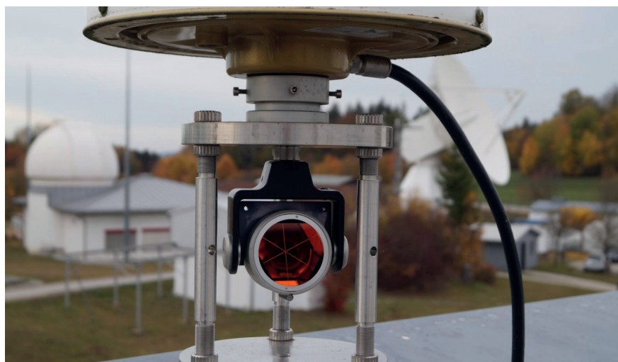
Bild 11: Das Combi-Target ermöglicht gleichzeitige Vermessung und GNSS-Beobachtung
