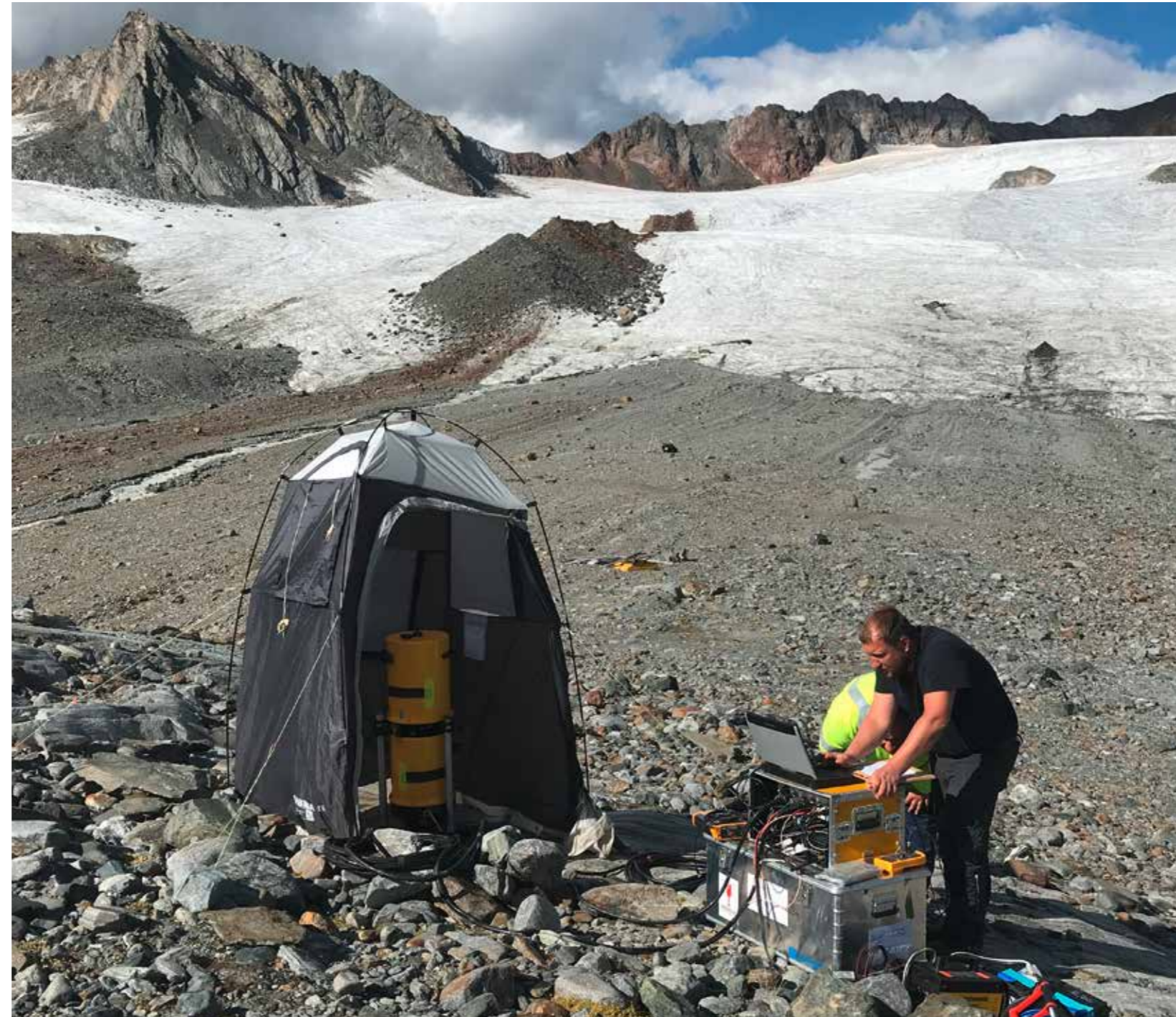
Messungen mit dem Feld-Absolutgravimeter A10-012. Das Zelt dient dem Schutz vor Sonne und vor allem Wind.
